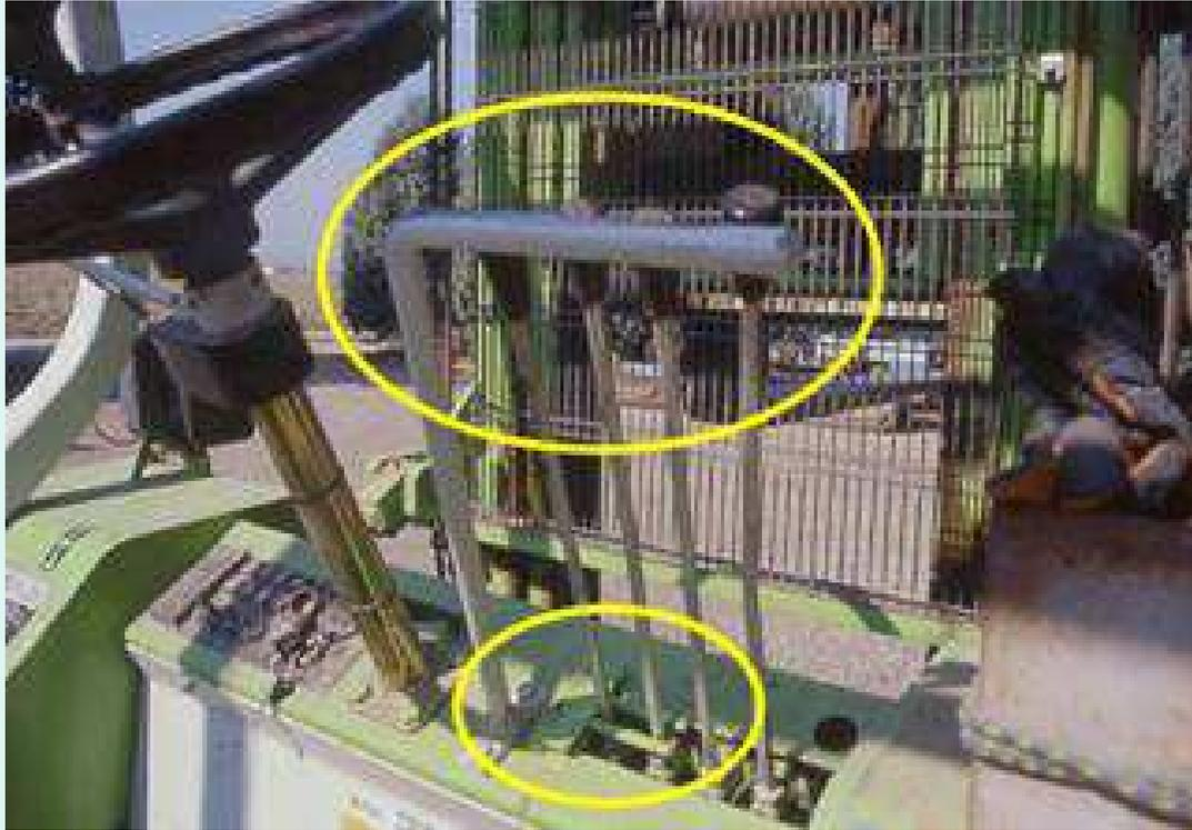
Sono altrettanto validi sistemi di comando per il cui azionamento sono necessari due movimenti ( es. traslazione laterale e poi azionamento in modo perpendicolare al posto di guida, etcc..)
