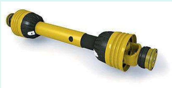
*l'albero cardanico deve avere una propria protezione in grado di coprire le parti salienti del giunto*
