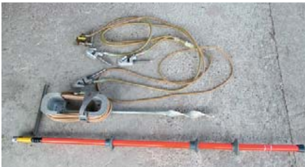
1 Apparecchiatura di messa a terra per alta tensione (Le apparecchiature di messa a terra devono sopportare sollecitazioni di tipo dinamico e termico)
