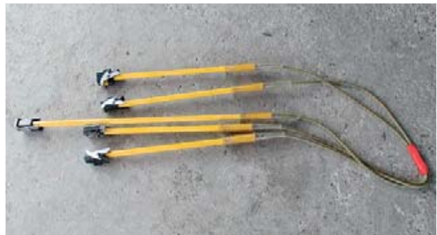
2 Apparecchiatura di messa a terra per bassa tensione
