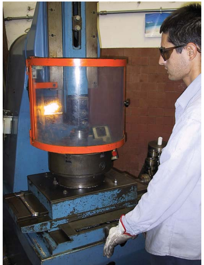
Foto n. 5 – Operazione di stozzatura
