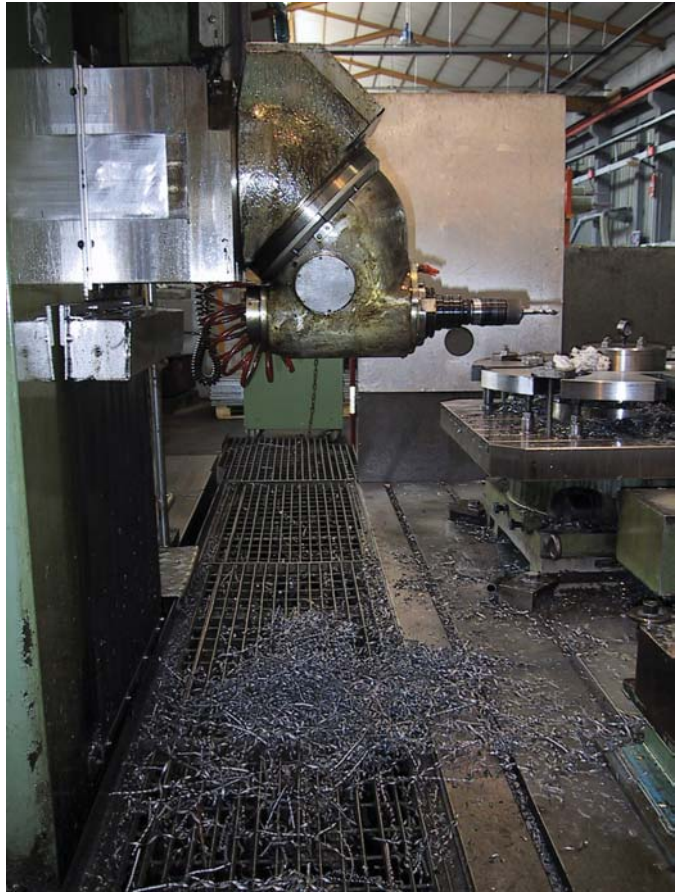
Figura 3 – Vista delle griglie di protezione delle fosse di raccolta
