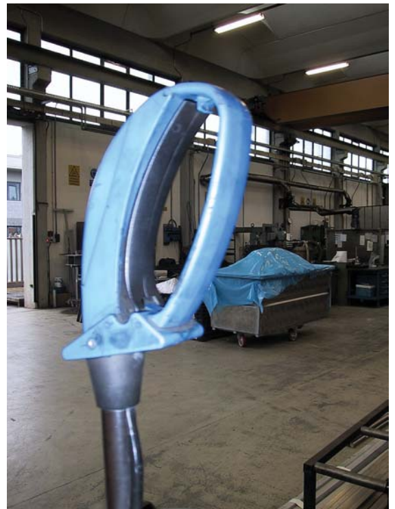
Figura 3 – Interruttore a pressione continua posto sull'impugnatura
