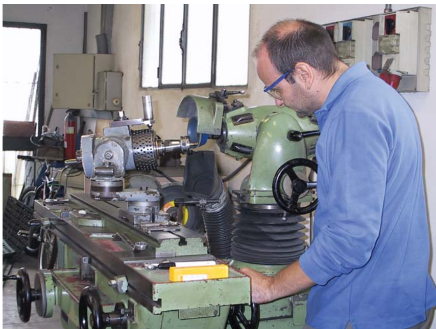
Figura 4 – Posizionamento slitta portautensili con volantino
