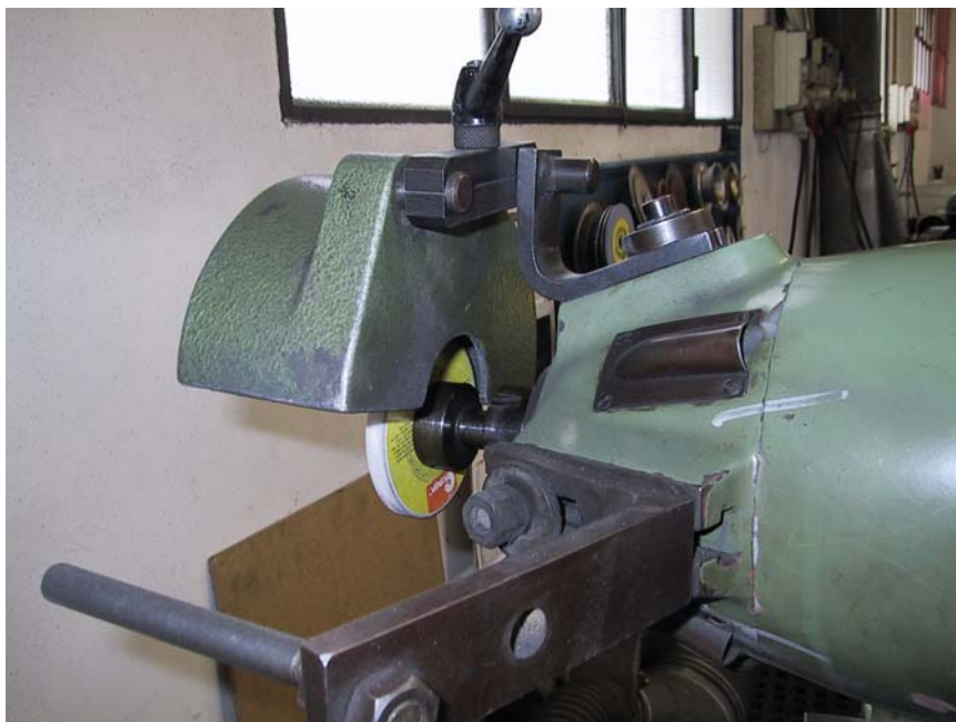
Figura 3 – Mola di una affilatrice con cuffia metallica di protezione
