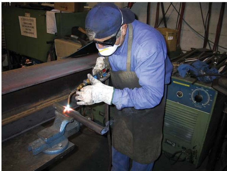
Figura 8 – Saldatura ossiacetilenica senza materiali di apporto
