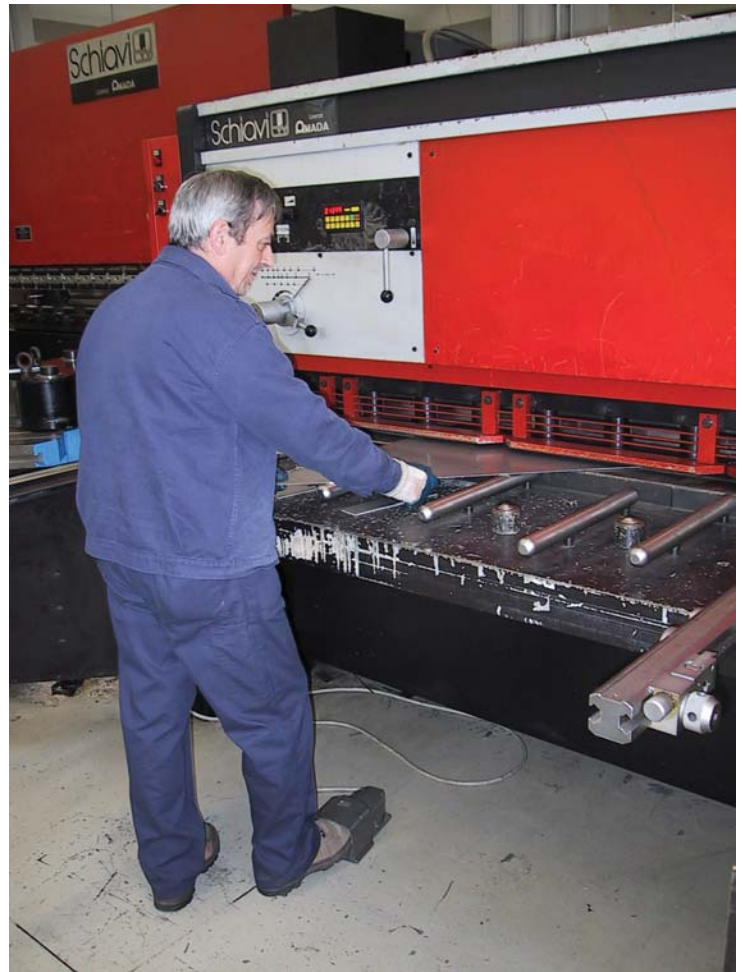
Figura 4 – Operazioni di taglio con uso di pedaliera ad uomo presente
