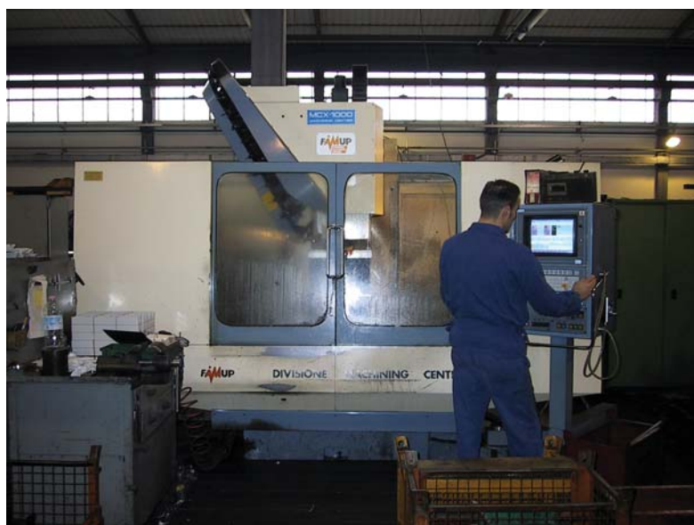
Figura 3 – Centro di lavoro in funzione
