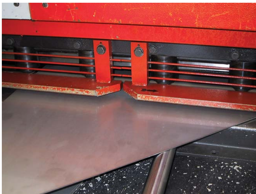
Figura 2 – Schermo fisso posto a protezione della lama e dei premi lamiera
