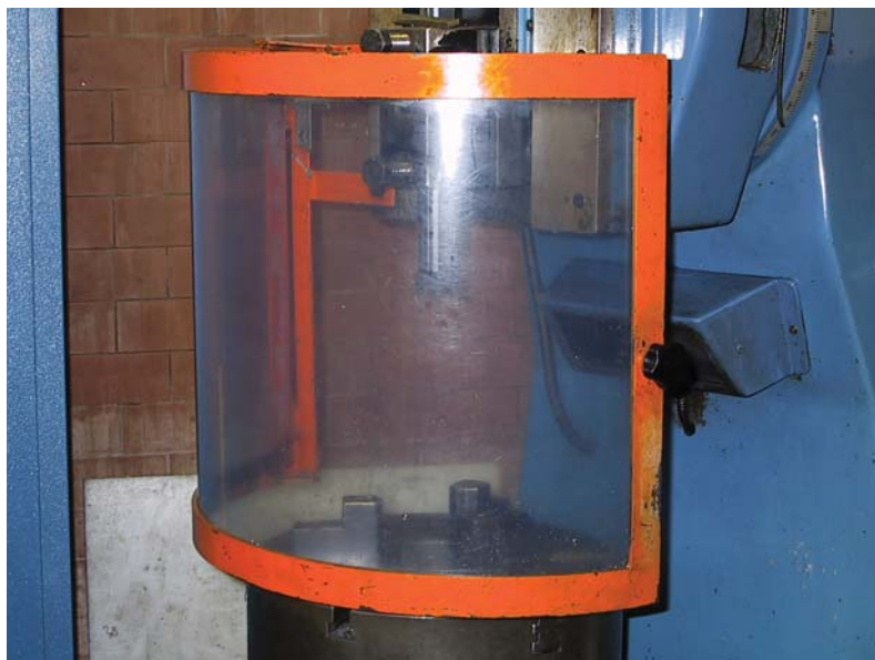
Figura 2 – Riparo mobile con dispositivo di blocco
