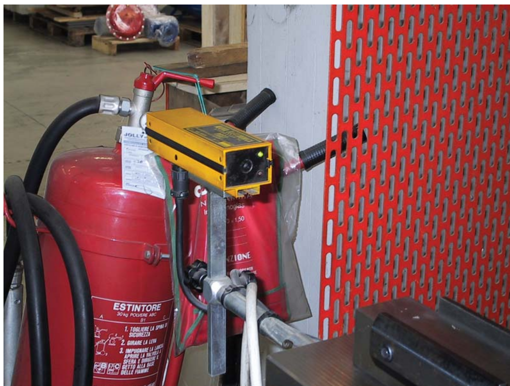
Figura 2 – Dispositivo di sicurezza a fotocellula
