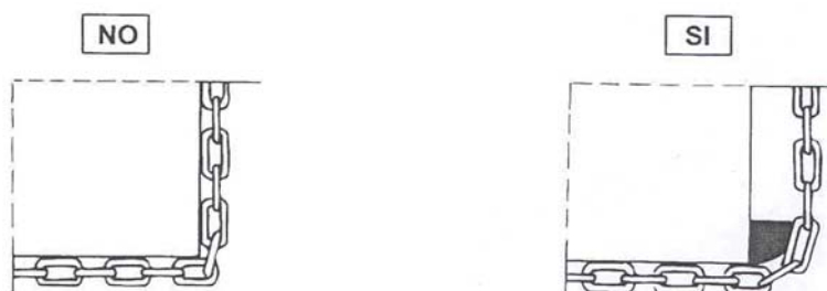
Figura 4 – Spessori per evitare danneggiamenti della fune o della catena
