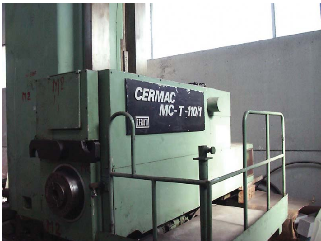
Figura 1 – Vista di insieme di una alesatrice orizzontale a montante fisso (ID98-CERMAC)
