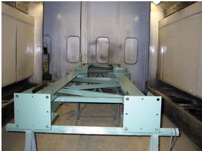
Figura 3 - Cabina di verniciatura a velo d'acqua
