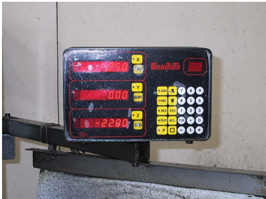
Figura 4 – Quadro di comando della fresatrice (notare i comandi per il moto del pezzo nelle tre direzioni X, Y e Z)
